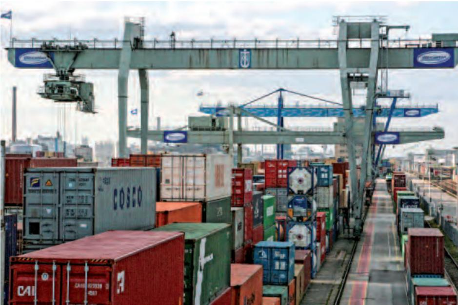
Der heutige Betreiber Contargo hat den Terminal letztes Jahr auf fünf Portalkrane erweitert. Die Kranfahrer setzen die bunten Metallkästen punktgenau innerhalb von 2 Minuten um. Das erfordert hohe Konzentration, Erfahrung und Fingerspitzengefühl.
