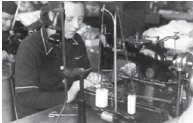
„Knopfloch-Maschine“ Aufnahme vermutlich Ende der 1930er Jahre.
