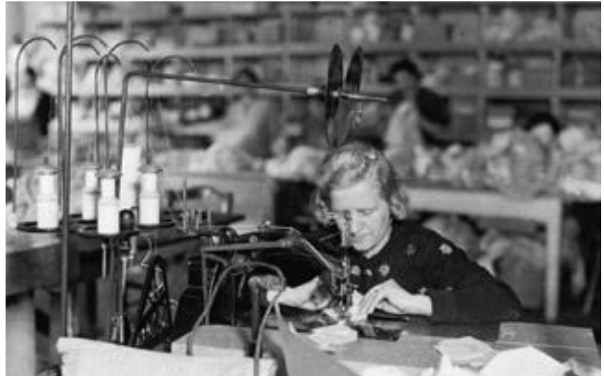
„Ränderüberdeck-Maschine“ Fotos Ende der 1930er Jahre.
